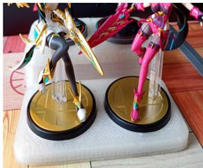
次に作ったのが amiibo の台。Xenoblade のホームラとヒカリ、ノアとミオを持っているのですが、2×2のひな壇のような台が欲しくて作りました。1段目の台を出力したとき、横が約115mmと長かったためか反ってシーソーのようになってしまいました。2段目のときは、1段目で出力したデータ(モデル)を半分に分割して最後に瞬間接着剤でくっつけました。とりあえず反ってはいませんが、真ん中に接合部があるのもなんだか見栄えが悪いような気がしました。
